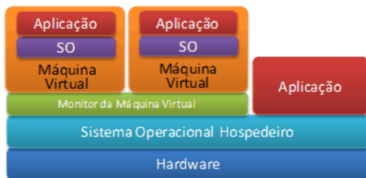
Figura 5. Arquitetura onde o hypervisor é parte do sistema operacional
